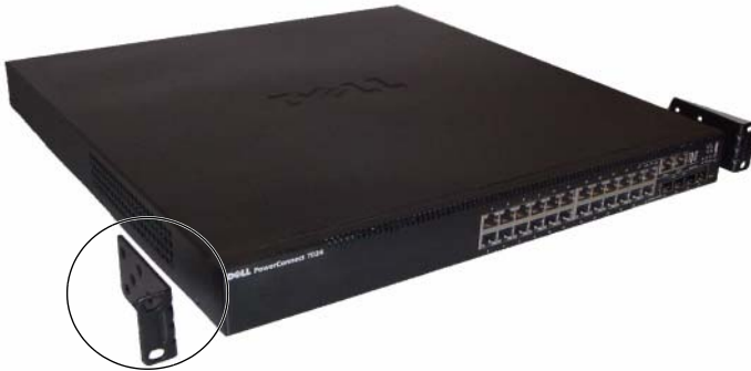
Ilustración 1-11. Fijación de los soportes
