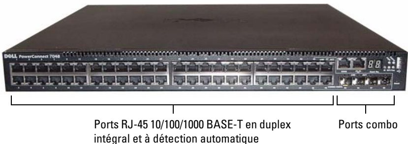
Figure 1-4. PowerConnect 7048 avec 48 ports 10/100/1000 BASE-T
