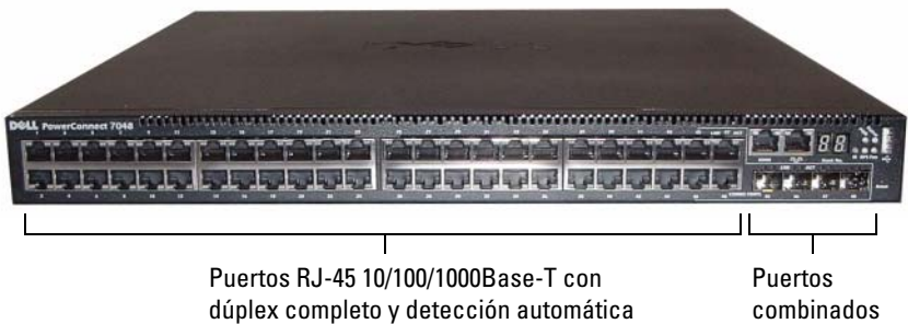
Ilustración 1-4. PowerConnect 7048 con 48 puertos 10/100/1000Base-T
