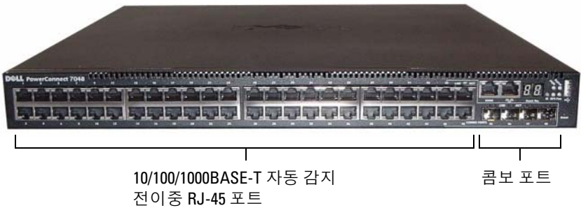
그림 1-4. 48개의 10/100/1000BASE-T 포트가 있는 PowerConnect 7048
